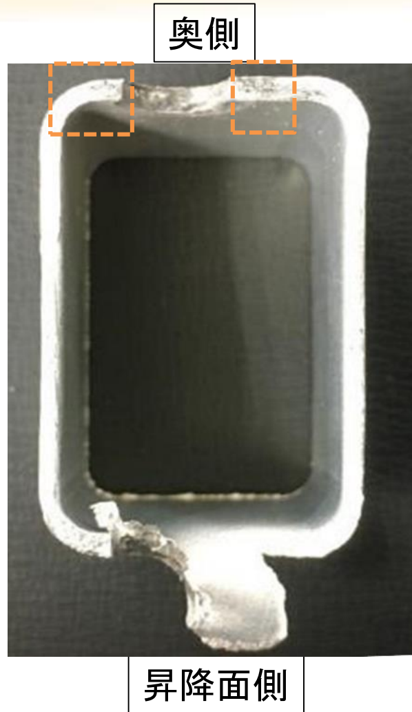
写真2 右支柱の破断面 (破断した支柱の下側)
